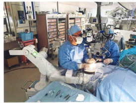
図4 眼科手術用にカスタマイズしたパッシブ型手術支援ロボットを用いての実験的硝子体手術
